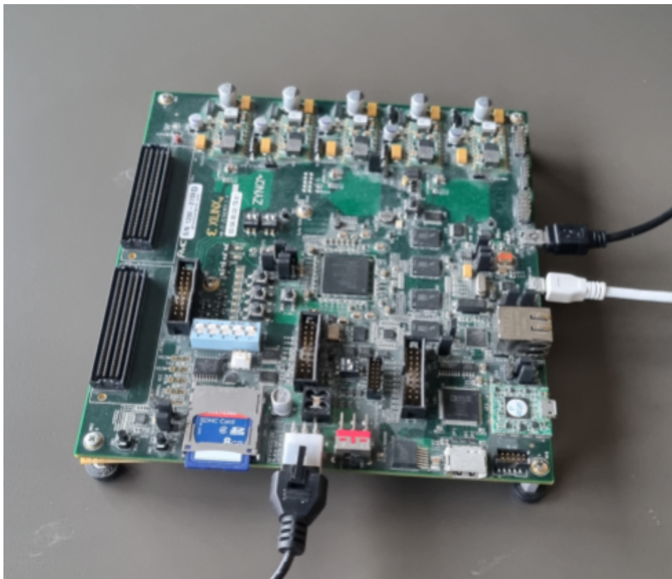
Obrázek 1: Fotodokumentace vzhledu funkčního vzorku. Na obrázku je funkční vzorek zabezpečeného senzoru založen na platformě Xilinx Zynq-7000 SoC ZC702 Evaluation Kit.
