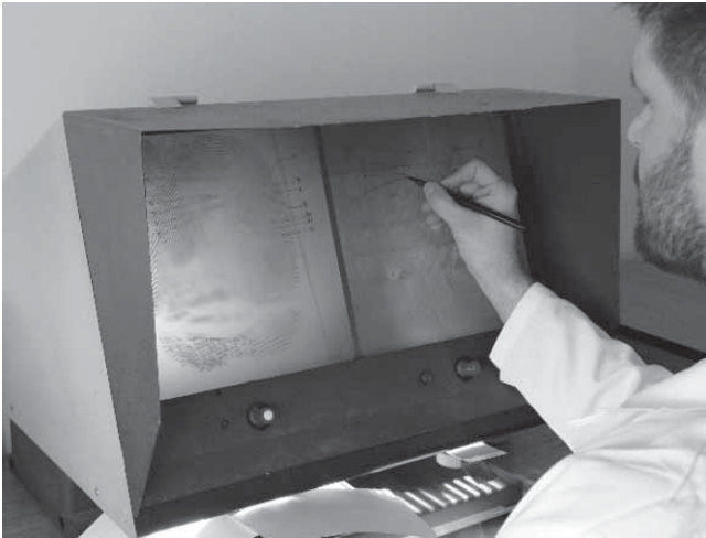
Abbildung 1.6 | Komparationsgerät (Vergleich von daktyloskopischen Spuren zweier Fingerabdrücke).
