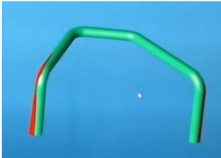
Obr. 3 Ukázka detekce ohnuté trubky v TubelInspectu, naměřené odchylky se pak pošlou zpět do ohýbače Wafios a podle nich se upraví program [3].
