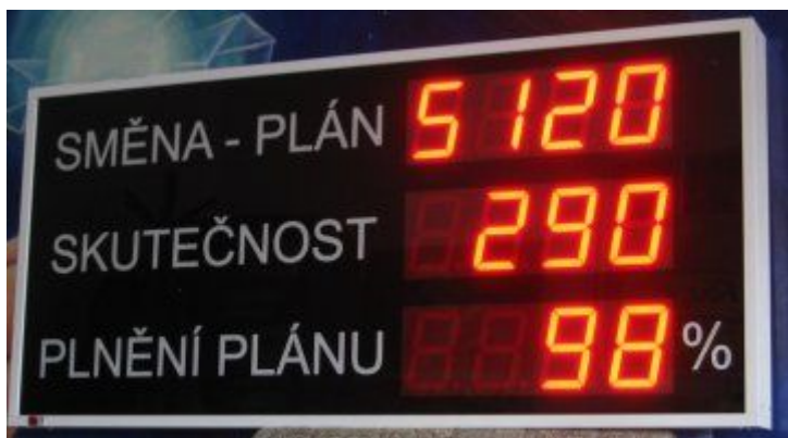
Obr. 6 Příklad LED panelu s vizualizací plnění výroby. Z hodnot je zřejmé, že reálně je plán plněn se skluzem 2%.
