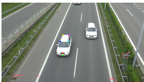
Obrázek 2: vlevo : Detekované 2D význačné body na snímku. vpravo : 3D souřadný systém kamery a odpovídající 3D pozice detekovaných význačných bodů.
